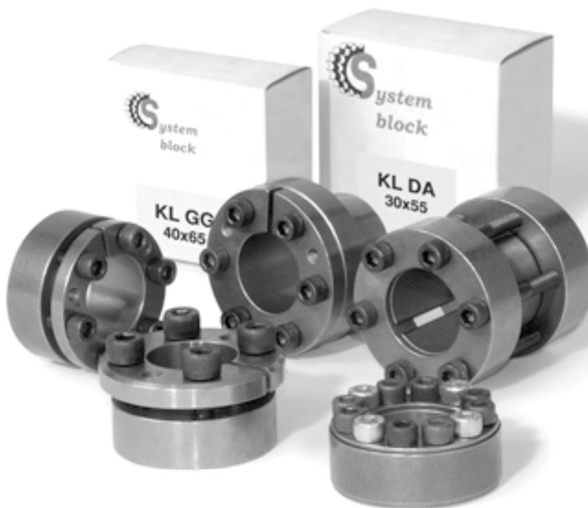
Il principio di funzionamento degli articoli presentati, si basa sulla deformazione radiale dei particolari, a profilo tronco conico, che li compongono: la coppia di serraggio applicata sulle viti di collegamento provoca un movimento assiale dei particolari a contatto tra loro ed, in funzione della conicità inversa del tagli longitudinali su di essi praticati, provocano un aumento di diametro (sull'anello esterno) ed una riduzione dello stesso (sull'anello interno).
